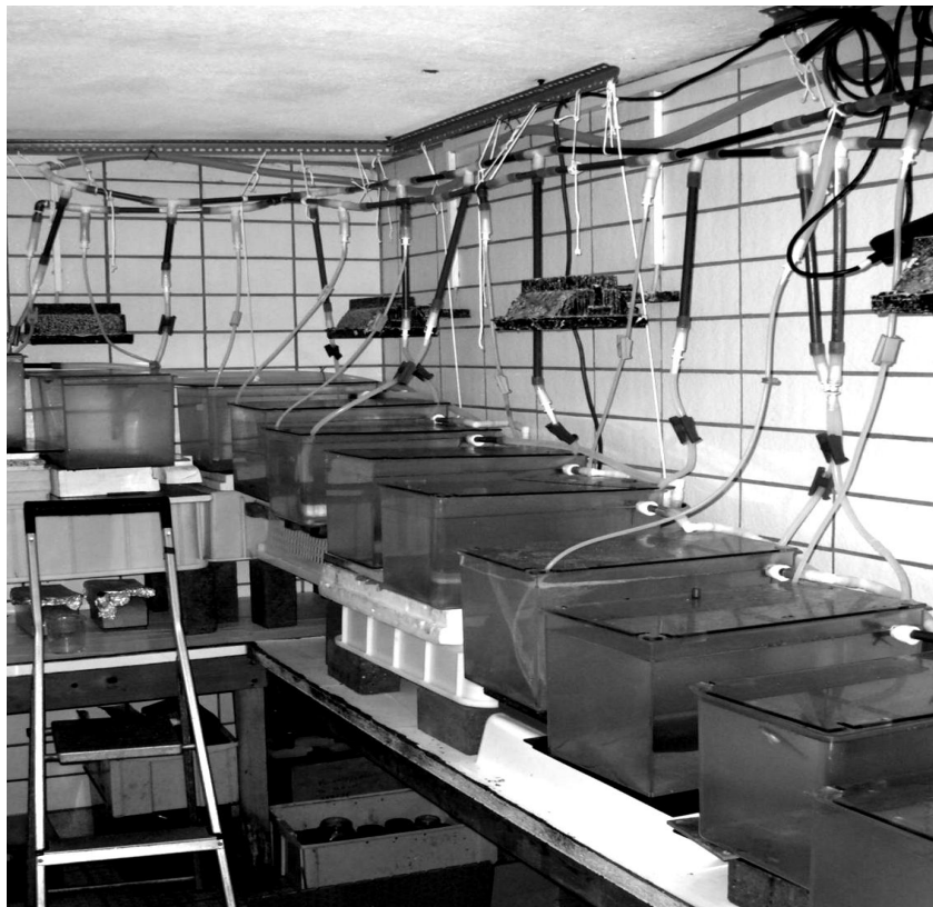
Abb. 2.2.: Hälterungsaquarien im Temperaturkonstanz-Raum. Die Aquarien mit 25 dm 3 Volumen waren jeweils mit einem eigenen Zulauf gefilterten Seewassers und mit einer eigenen Sauerstoffzufuhr versehen.
