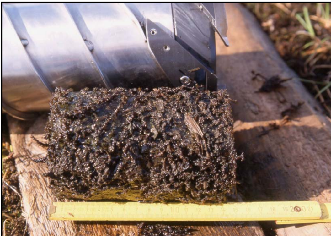
Abb. 7-11: Im subaquatischen Eiskeilrücken des Standortes IS erbohrter Eiskern (durchsetzt mit toter organischer Makrosubstanz).
