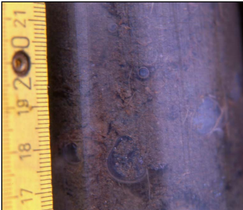
Abb. 7-13: Im See PS2 entnommener Sedimentkern mit eingeschlossenen Gasblasen.
