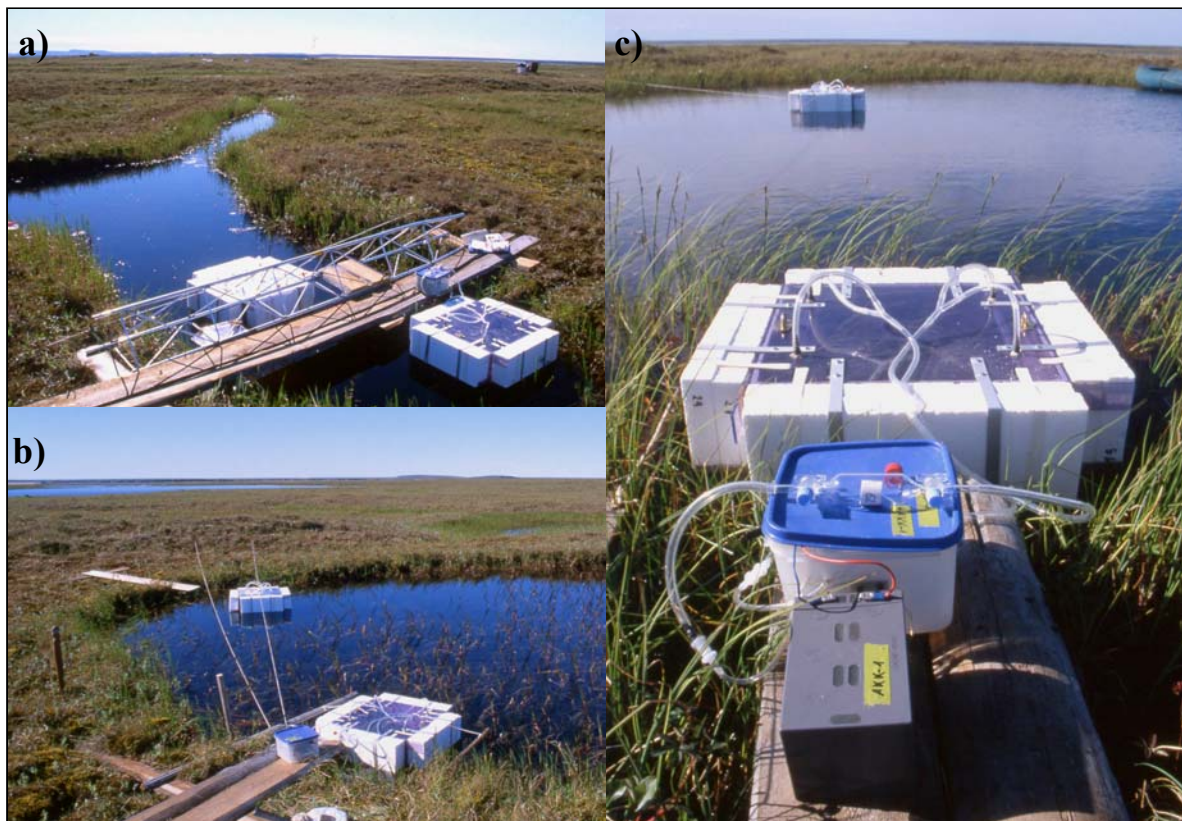
Abb. 6-2: Installierte Emissionsmesshauben an den drei Untersuchungsstandorten IS (a), PS2 (b) und PS1 (c) (August 2002).
