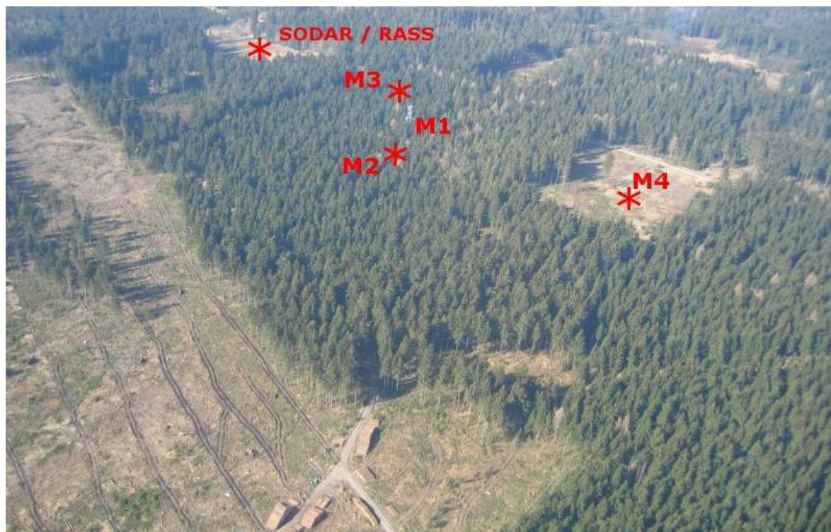
Abb. 3-2: Anordnung der Messkomplexe auf dem Versuchsfeld bei EGER, IOP 1 (Serafimovich et al., 2008a)
