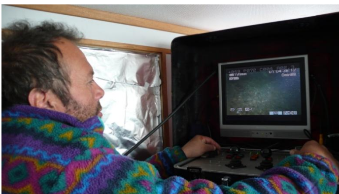
Abbildung 10: Kontrollmonitor des ROVs mit darunterliegender Steuereinheit für den Piloten.
