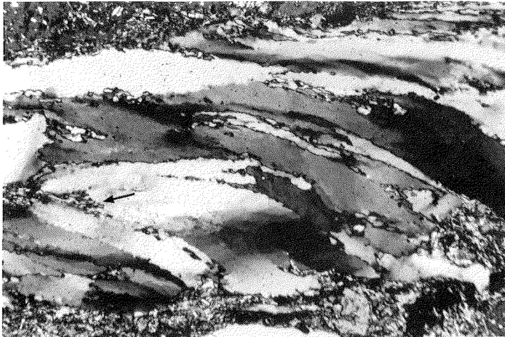
Abb. 5.-5: Probe KJ 01, protomylonitischer Augengneis, Leabotnen. Stark geplättete Quarzkristalle mit einsetzender Rekrystallisation an den Korngrenzen (Pfeil). X Nicols, Länge der unteren Bildkante 1,3 mm.
