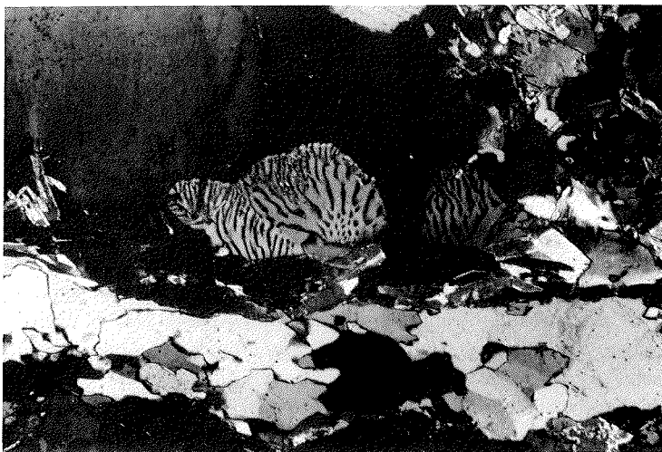
Abb. 3.-5: Verdrängung von Kalifeldspat durch Myrmekit. Zu beachten ist der helle Albitaum am Rand des Myrmekits. X Nicols, Länge d. unt Bildkante 1,3 mm.
