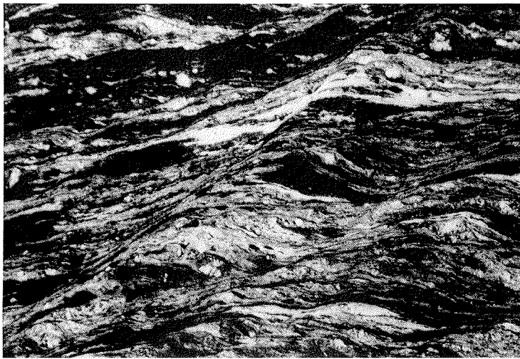
Abb. 3.-9: SCC'-Gefüge in einem mylonitisierten basischen Dyke (KS 05), X Nicols, Länge der unteren Bildkante 3,2 mm.
