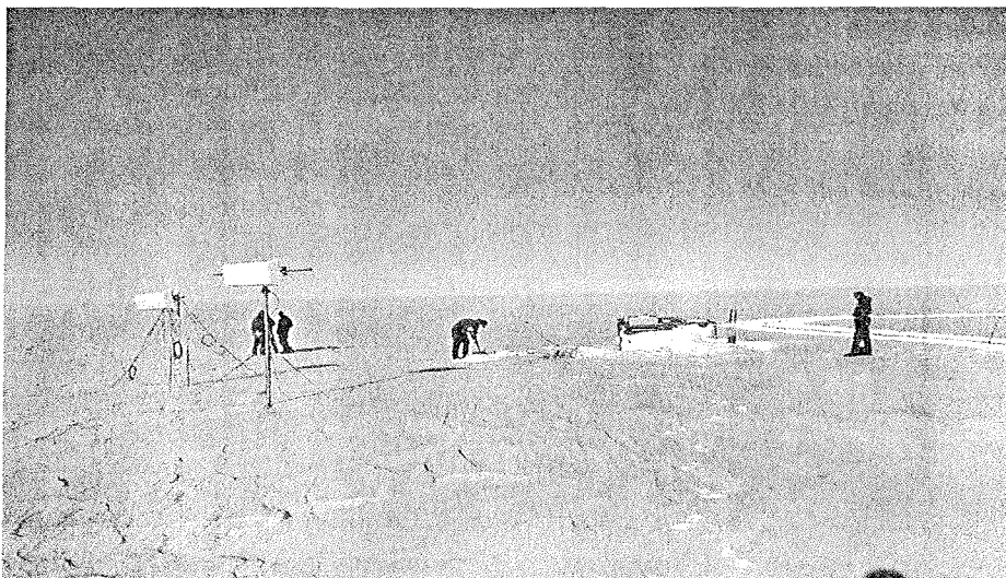
Abb. 6: Station WATZMANN: der Container am Detektions-Array im Februar 2000 vor Beginn der Ausgrabungsarbeiten. Der Container konnte während der letzten drei Jahre seit seiner ersten Aufstellung im Februar 1997 nicht höher gesetzt werden.
