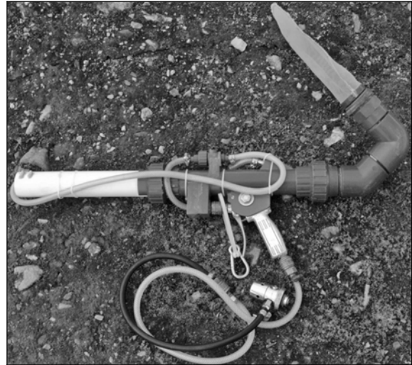
Abb. 4: Airlift System (Länge von 80 cm)
