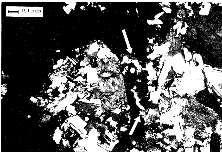
Abb. 3: Salzsprengung durch Gipskristalle innerhalb Doleritgestein. Pfeile zeigen den Gips an. Weggebrochenes Gesteinsstück auf der linken Bildseite. Gekreuzte Nicols, Vergrößerung: 77fach.
