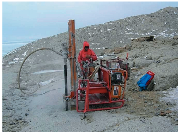
Abb. 3: Bohrung im Permafrost von Viktorialand zur Einrichtung von Dauermessstellen (Foto: M. Guglielmin 2007, ANTPAS Meeting Santa Barbara).
