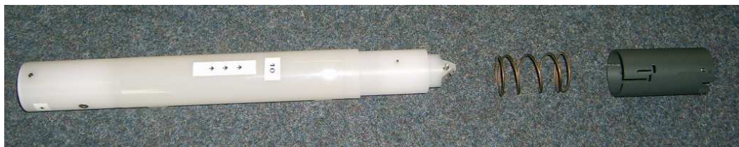
Abbildung 6.1-4: Anbringen des beweglichen Endstücks
