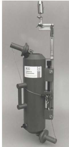
Abbildung 4.2-4: Niskin-Flasche, Quelle: KC Denmark
