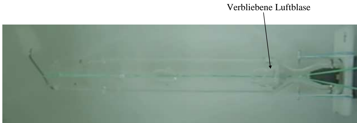
Abbildung 7.2-4: Reste der Luftblase nach Durchströmung
