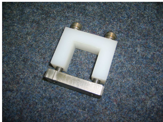
Abbildung 6.4-5: Halterung des Wasserprobennehmers im AUV
