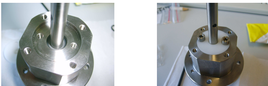
Abbildung 6.2-4: Dichtungsnut der Rotationsdichtung offen (links), geschlossen (rechts)
