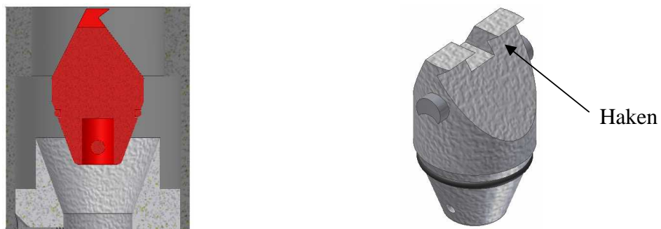
Abbildung 5.1-12: Verschlusskegel in der Röhre (links) und hakenförmige Struktur
