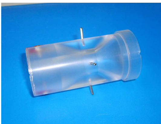
Abbildung 7.1-1: Modell von Einlass und Verschlusskegel
