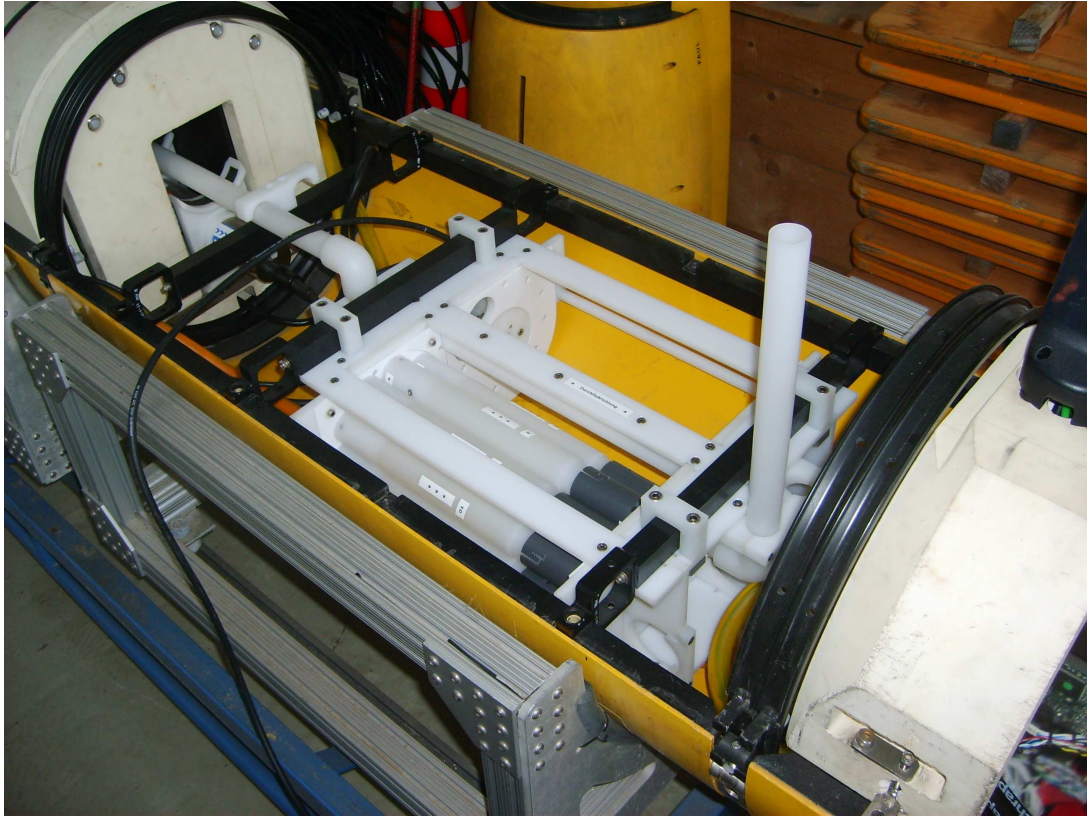
Abbildung 6.6-1: Wasserprobennehmer im AUV
