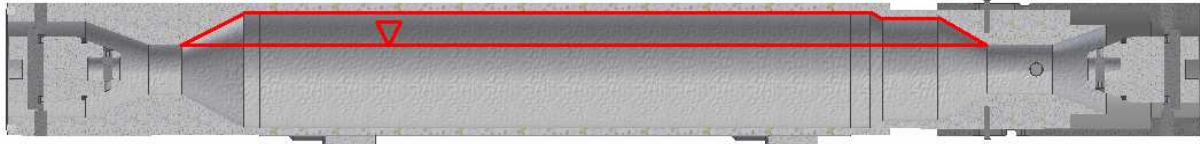
Abbildung 7.2-1: Totvolumen in der Probenröhre
