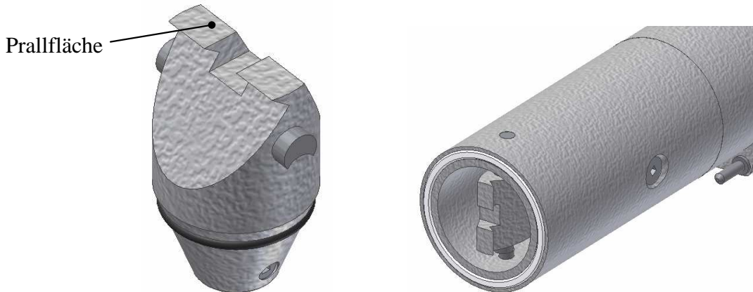
Abbildung 5.1-30: Prallfläche am Verschlusskegel (links), Position in der Röhre (rechts)
