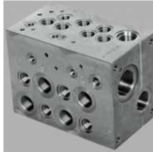
Abbildung 4.3-1: Hydraulikverteiler, Quelle: Moser Entgratungs AG
