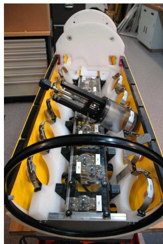
Abbildung 4.2-3: Probennahmesystem GULPER, Quelle: MBARI
