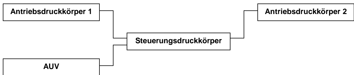
Abbildung 5.5-1: Anschlussplan des Wasserprobennehmers
