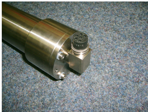
Abbildung 6.2-7: Wasserdichte elektrische Zuleitung zum Antriebsdruckkörper
