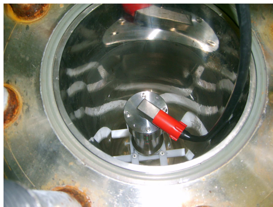
Abbildung 7.3-2: Antriebsdruckkörper im Drucktank
