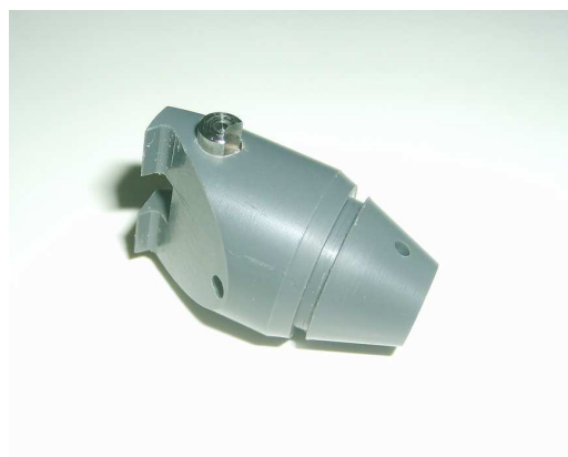
Abbildung 7.1-1: Modell von Einlass und Verschlusskegel
