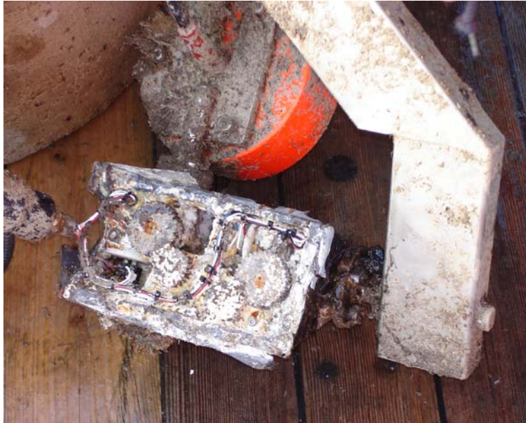
Abb. 1.4.13: Die beschädigte Schwenk-Neige-Einheit des stationären Echolots nach der Bergung im Oktober 2007 an Deck der Heincke.
