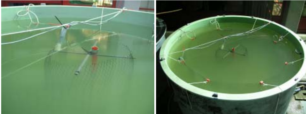
Abb. 1.4.32: Aufsicht in das Becken V (2,5 m Durchmesser) mit der Kathode (Drahtmatrix) am Außenrand des Beckens (Bild links) und Aufsicht mit innen liegender Anode (rechts).
