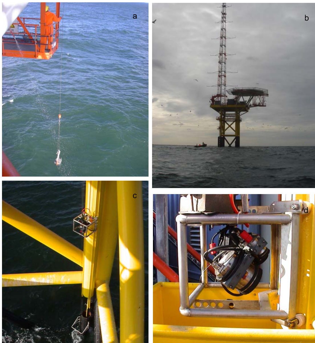
Abb. 1.4.2: Probennahme auf FINO 1 a) Beprobung des Sediments und der Weichbodenorganismen mit dem van Veen-Greifer; b) Beprobung des Bewuchses der Pfeiler durch Taucher; c) und d) Unterwasserkamera auf FINO 1.
