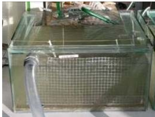
Abb. 1.4.29: Becken I mit Gitterfläche am Boden und Vorderseite als L-Form.
