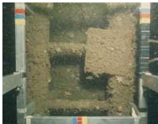
Abb. 1.4.6: Besiedlungsplatte (20 x 20 cm) in 11 m Wassertiefe (mit Fotorahmen) zur Dokumentation der tiefenabhängigen Kolonisierung künstlicher Hartsubstrate an der Unterwasserkonstruktion von FINO 1 im Herbst 2006 nach einem Jahr der Exposition.
