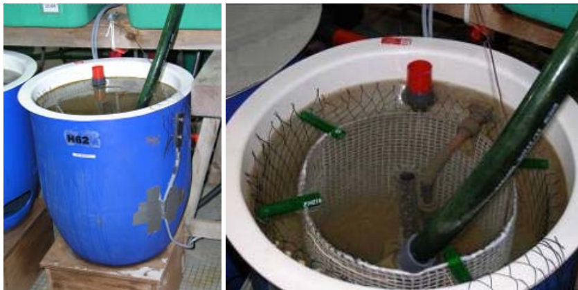
Abb. 1.4.31: Becken III mit innen liegender Kathode und außen liegender Anode (rechts), der grüne Schlauch ist die Wasserzufuhr aus den darüber liegenden Hummerbecken.
