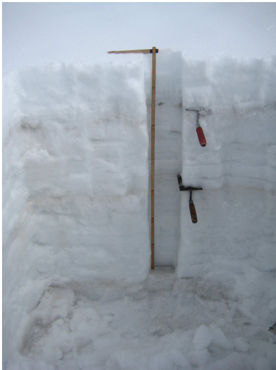
Foto 1. linkes Bild: Herbstschacht mit deutlichen Schmutz- und Altschneehorizonten Foto 2. rechtes Bild: Einmessen der Felsinseln mit DGPS am 31.08.2009
