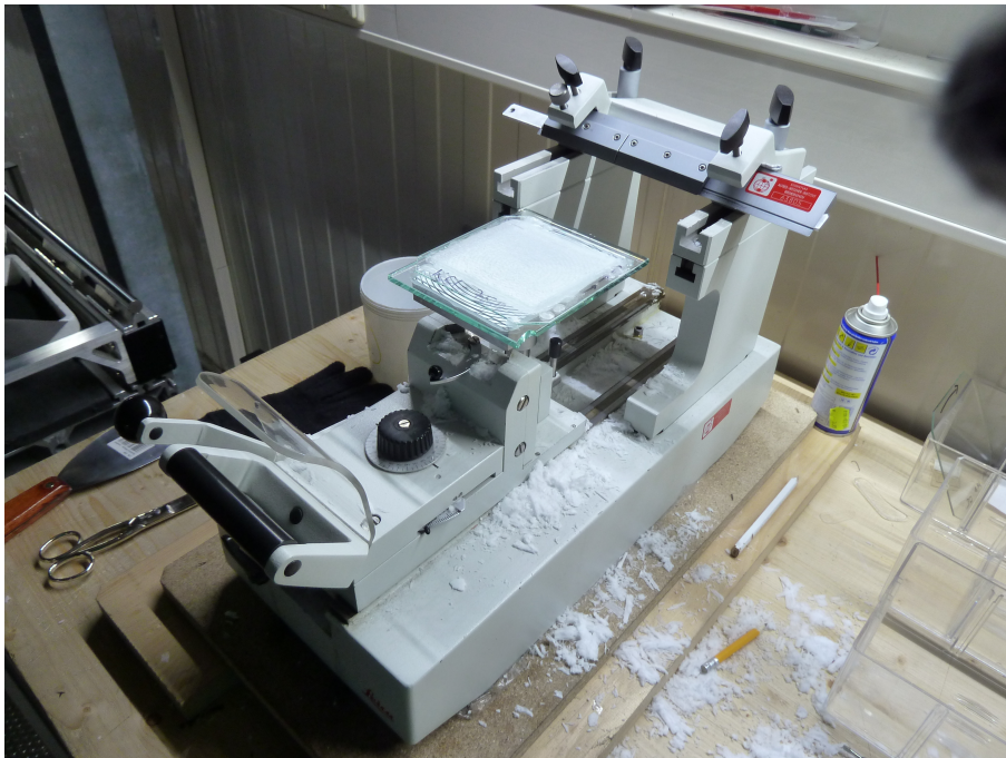
Abbildung 8: Mit dem Mikrotom werden 250\ \mu\text{m} dünne Eisschnitte angefertigt.
