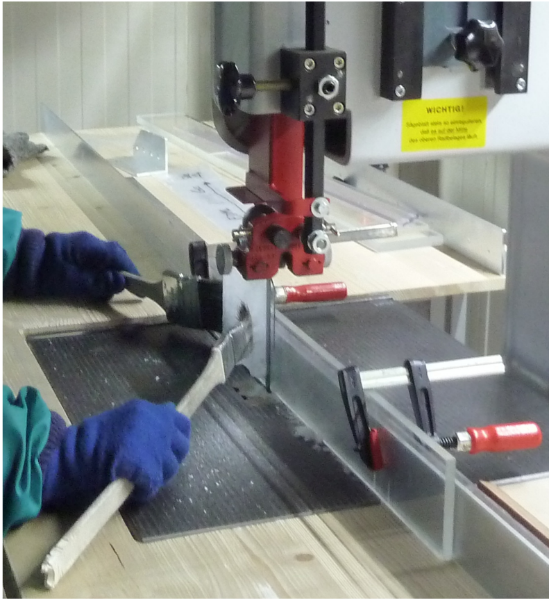
Abbildung 9: Bandsäge zum Schneiden von Eiskernproben
