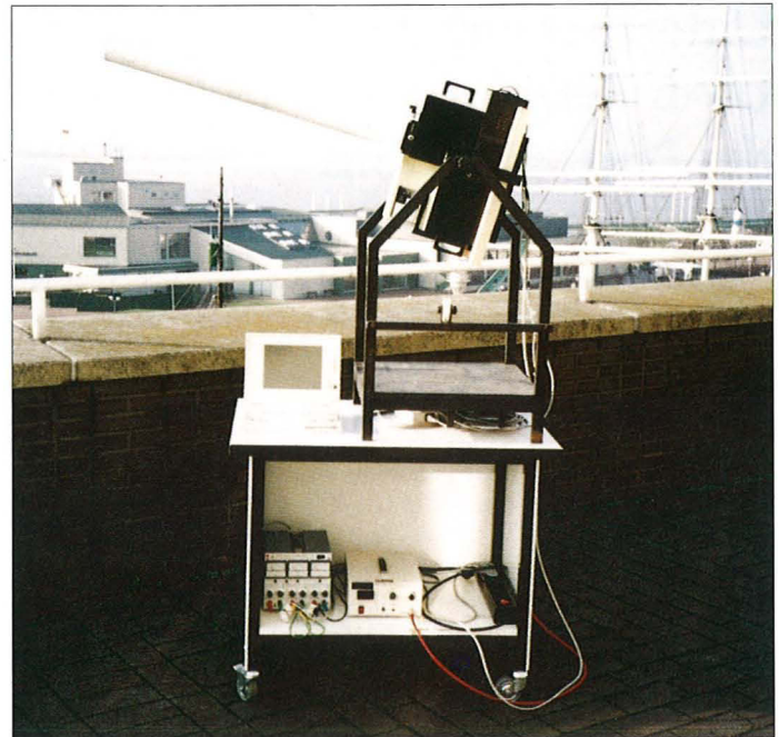
Abb. 2: Kalibrierung des UV-B Spektrometers durch photometrischen Anschluß an das Sonnenspektrum.
