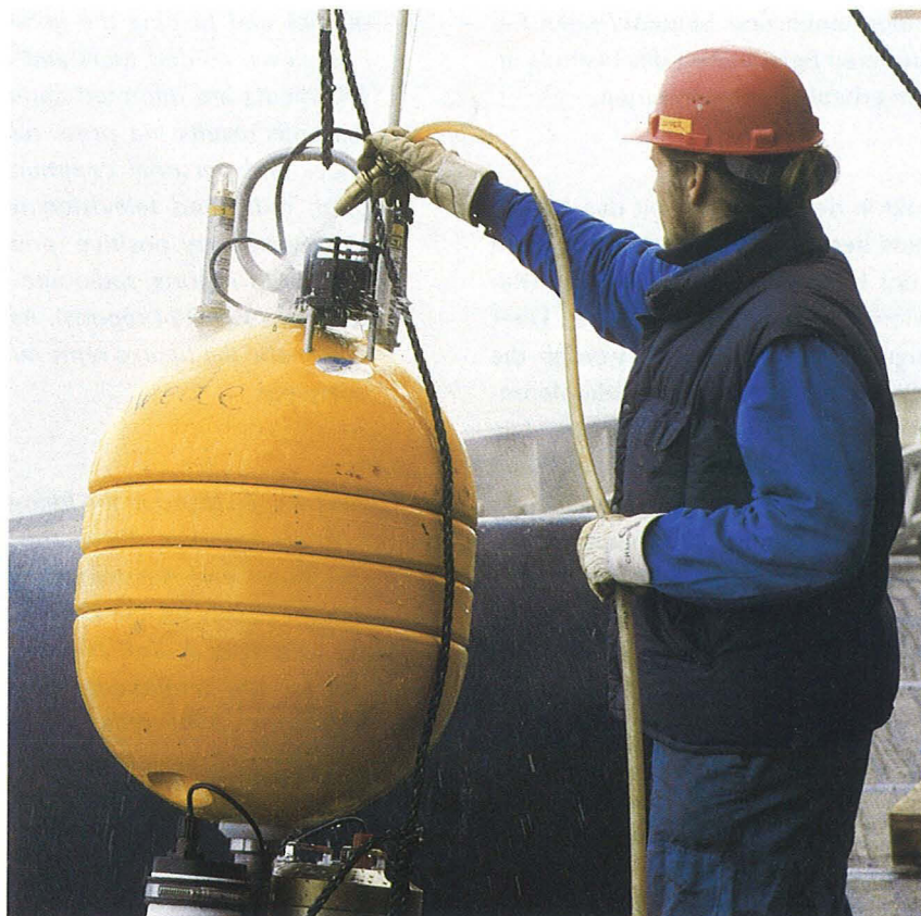
Reinigung eines Ozeanbodenseismometers Cleaning an ocean bottom seismometer
