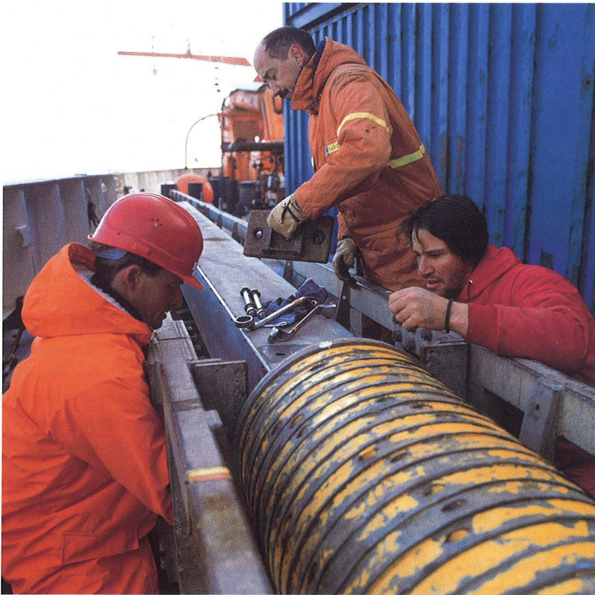
Vorbereitung des Kastenlots Preparation of the kasten corer
