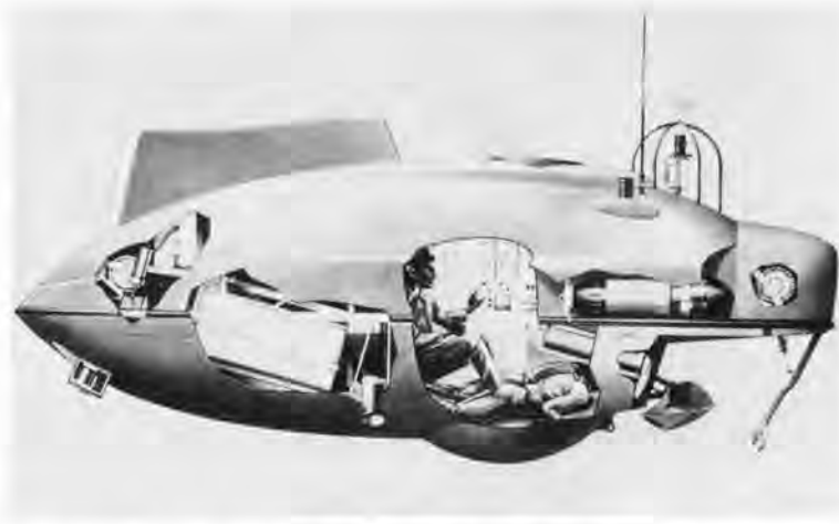
7. La soucoupe Cyana (écorché). En plongée, pilote et observateur scientifique sont couchés vers l'avant, les yeux aux hublots, le navigateur est assis derrière eux.
