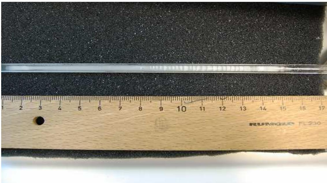
Abbildung 57. Pfropfenbildung in der Glaskapillare
