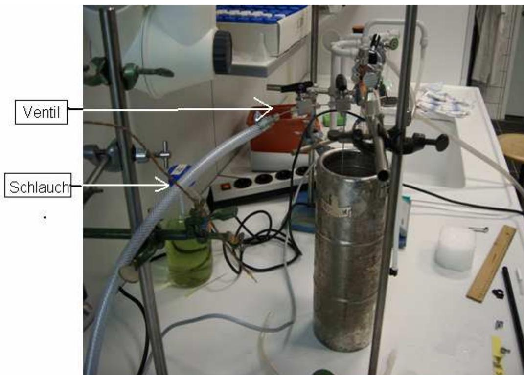
Abbildung 58. Ausbaustufe II der Kühlfalle
