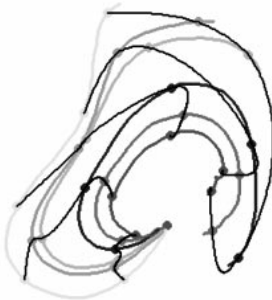
Abb 6.5: Darstellung einiger durch Splineinterpolation bestimmter Raumkurven, die die Orte der Luftpakete für alle Höhen zu verschiedenen festen Zeitpunkten t_0 angeben, am Beispiel der Trajektorien zum Sondenaufstieg 1.1.'92 in Ny Ålesund. Die Farbzuordnung der Trajektorien siehe bei Abb 6.1. Die Projektionen der fünf Raumkurven in die (x,y) -Ebene sind schwarz eingezeichnet.
