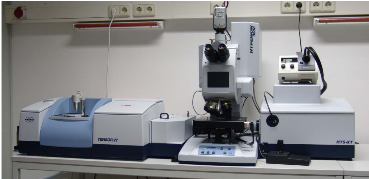
Abbildung 5: Messaufbau bestehend aus dem FTIR-Spektrometer „Tensor 27“, dem Mikroskop „Hyperion 3000“ und dem Microplate Reader „HTS-XT“ (von links nach rechts)
