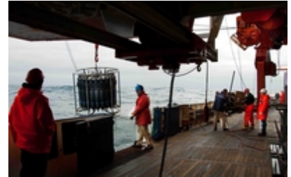
Arbeiten an Deck: Die CTD (links) kommt aus dem Wasser, das Kolbenlot wird zum Einsatz vorbereitet. (Foto: S. Fietz)
