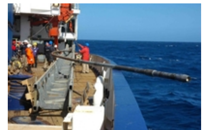
"Banane" an Deck - ein 25 m Kolbenlot am Meeresboden verbogen. (Foto: Marcel Arevalo)
