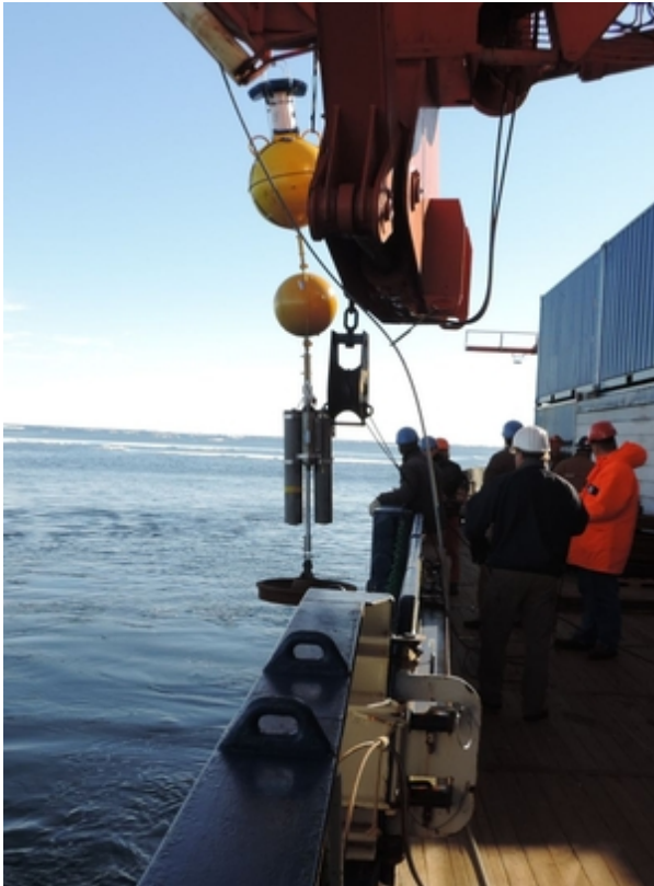
Abb.2: Eine komplett zusammengebaute UDel-verankerung geht zu Wasser (Photo: A. Muenchow)
