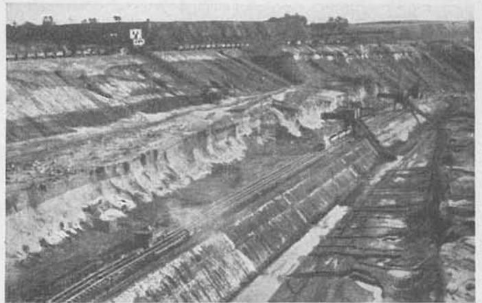
Abb. 20. Blick in den Tagebau der Bernsteinwerke bei Kraxtepellen-Palmnicken. Zu unterst der „Sumpf“. Darüber Anschnitt der „Blauen Erde“ mit schichtweise austretendem Wasser; im nächsthöheren Anschnitt der „obere Triebssand“ die „graue“ und die „grüne Mauer“; der darüber folgende, mehr abgeschrägte Schichtenstoß enthält Sande und Letten der „Braunkohlenformation“, der dunkel erscheinende oberste diluvialen Geschiebemergel. Der „Sumpf“ liegt ca. 14—15 m, die Oberkante der Blauen Erde ca. 1 m unter dem Ostseespiegel.
