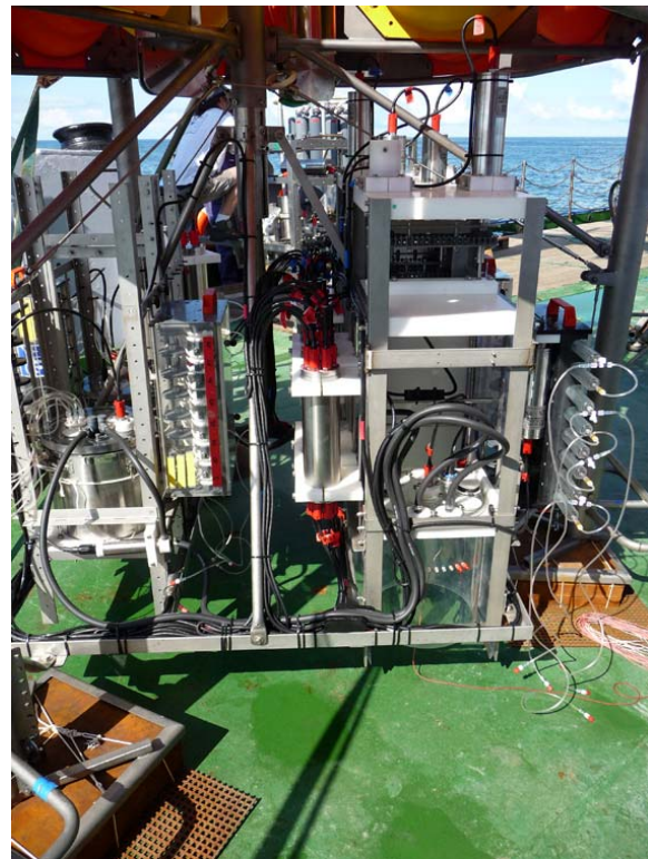
Abb. 5: Mesokosmos mit Spritzenprobennnehmer (rechts) und Oxistat Reservoir mit Probennehmer (links).
