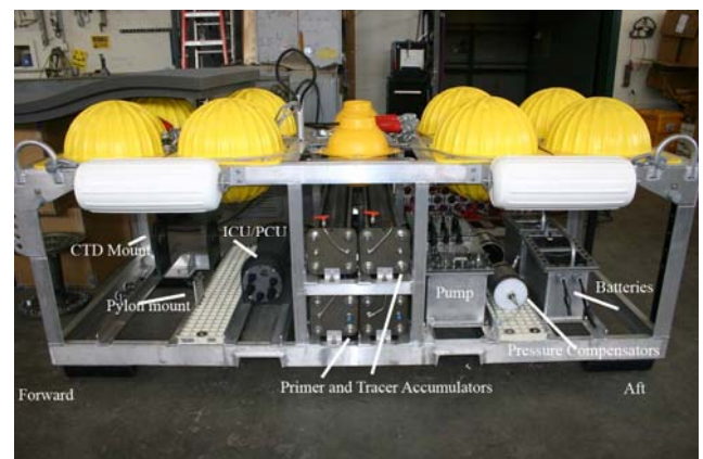
Abb. 5 Foto von dem Ocean Tracer Injection System (OTIS) bei der Anlieferung zum IFM- GEOMAR
