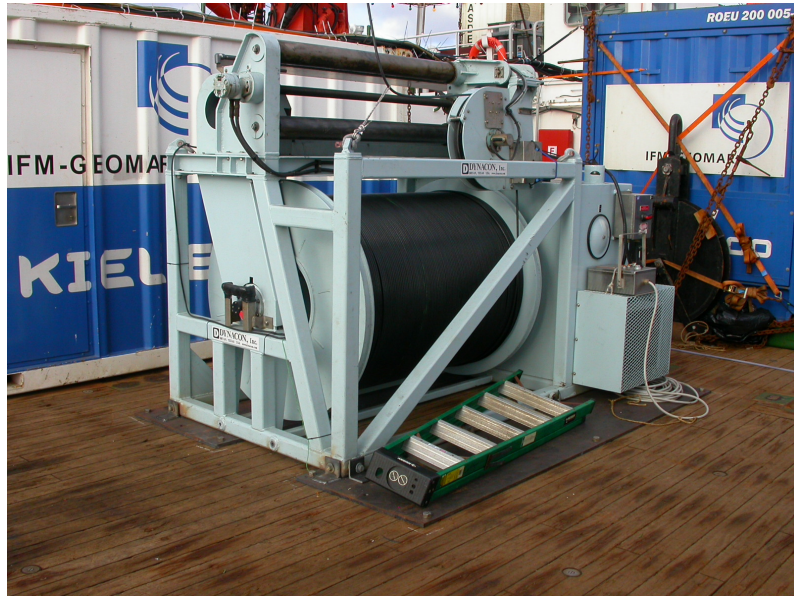
Abb. 2: Mobile Winde mit Kevlaer-Kabel
