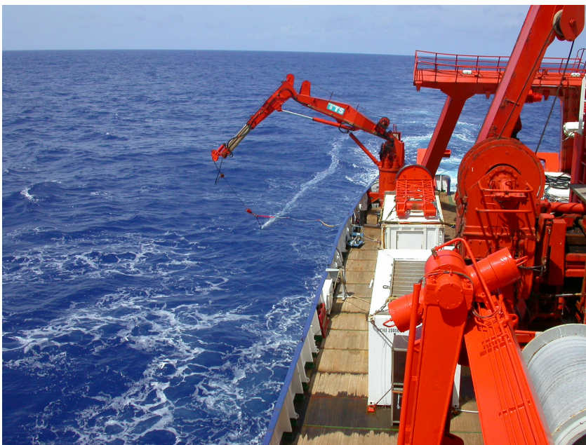
Abb. 1: Der Schleppfisch des IFM-GEOMAR im Einsatz an einem Kran der Meteor..
