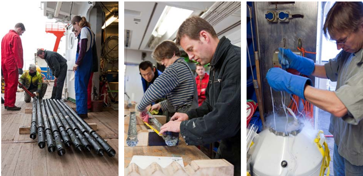
Abbildung 2: MeBo-Kernrohre von der gerade beendeten Bohrung auf dem Pechori Mound (links), Bearbeitung der Sedimentkerne im Geolabor (mitte), Sicherung der Gashydratproben in flüssigem Stickstoff (rechts; Fotos Volker Diekamp, MARUM, Bremen).
