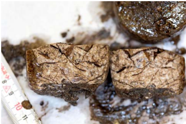
Abbildung 1: Gashydratstücke aus der MeBo-Bohrung 67. Die Gashydrate dieser Bohrung sind durch die Assoziation mit natürlichem Öl bräunlich dunkel verfärbt (links). 3-D-Darstellung der Methanemissionen am Kulevi Rücken (rechts).
