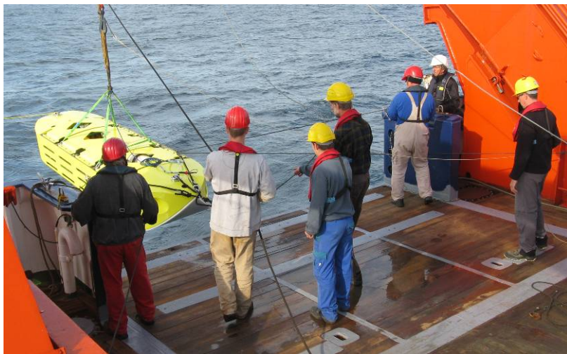
Abb.: Der neue Elektromagnetik-Schlitten MARUM Neridis III im ersten Einsatz auf offenem Ozean.
