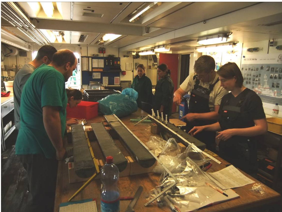
Routinearbeit im Geolabor: Der frisch geöffnete Sedimentkern wird von den Spezialisten im Detail beschrieben, fotografisch festgehalten und danach sorgfältig beprobt.
