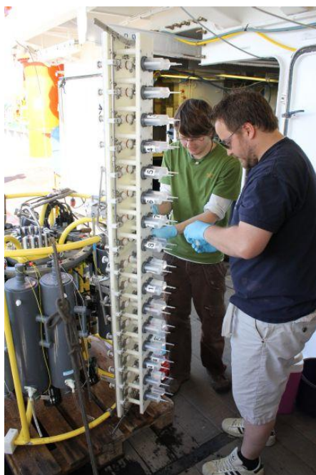
Abb. 5: Links: Probenahme am IOW-Spritzenschöpfer. (Foto: I. Schuffenhauer). Rechts: Profile von Nitrat und Sulfid entlang des 1,6 Meter-Gradienten (unvalidierte Daten, K.Jürgens).
