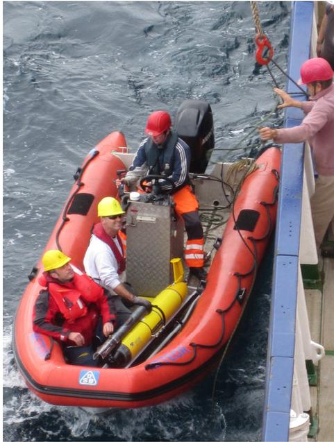
*Nach der erfolgreichen Bergung des Gleiters kommt die Schlauchboot Besatzung sichtlich erleichtert von ihrer Mission zurück zur METEOR. Über dem gelben Körper des Gleiters ist die graue Mikrostruktursonde zu sehen, die huckepack auf dem Tauchkörper mitfährt. Die seitlichen Tragflächen sind bereits abgebaut.*
