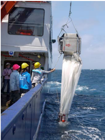
Multi-Netz zum Fangen von Plankton in unterschiedlichen Wassertiefen. (Foto: Martin Visbeck)
