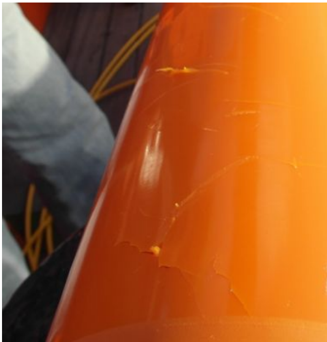
Haifischbisse auf der Magnetometerhülle
