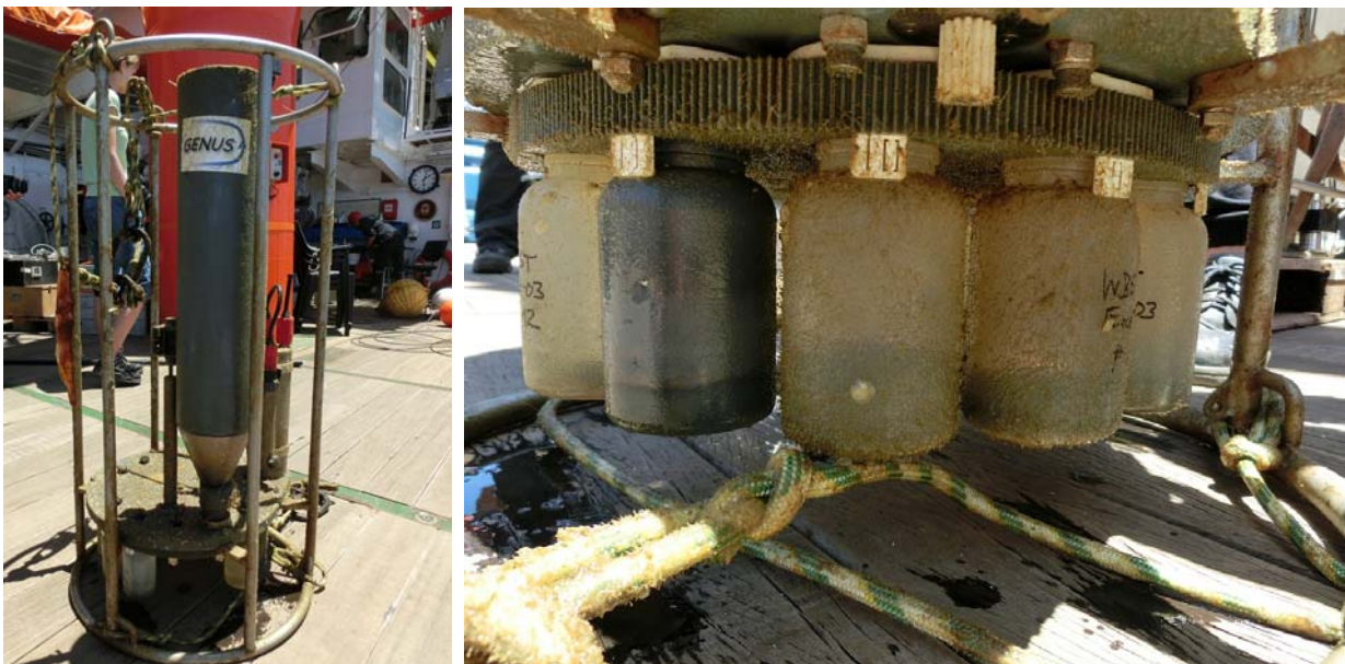
Abb. 1: Die geborgene Sinkstoff-Falle zurück an Deck (links), teilweise stark von Organismen überwuchert.
