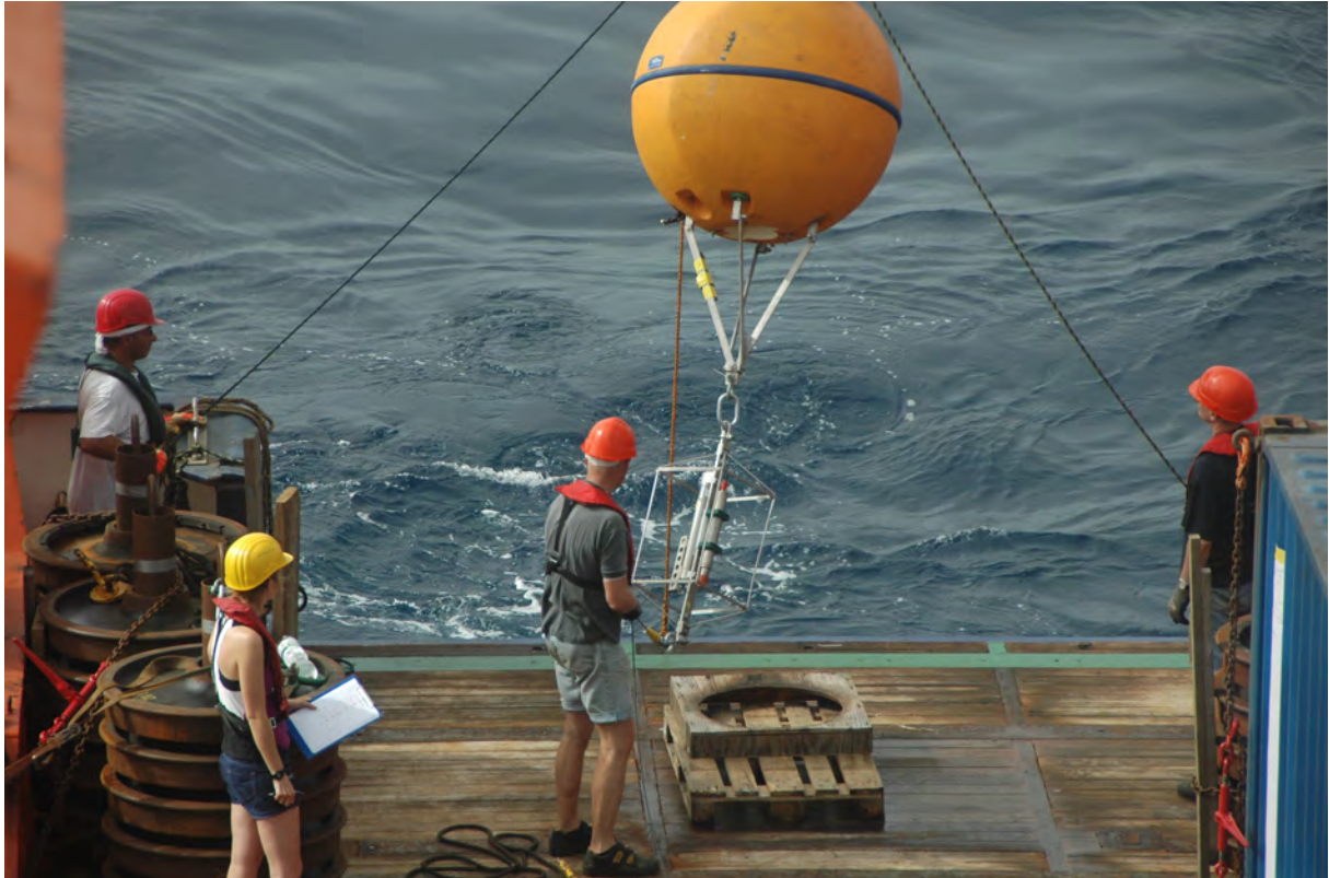
Abb. 3: Auslegung der Kopfboje unserer Verankerung bei etwa 21°W, 11°N vom Heck der Meteor. Unterhalb der Kopfboje befinden sich Instrumente mit Sauerstoff-, Temperatur-, Salzgehalts-, und Drucksensoren (Foto: Michael Schneider).
