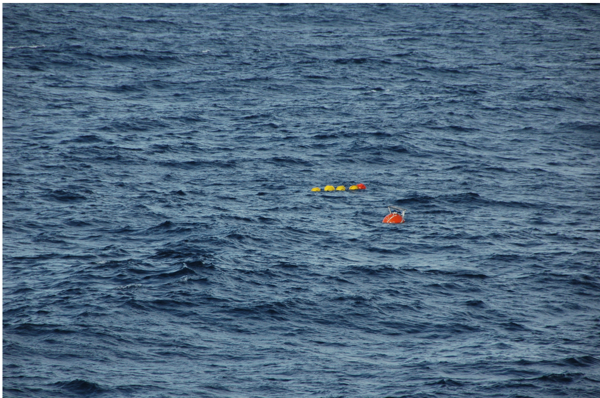
Abb. 1: Das Auftauchen einer Verankerung ist immer ein spannender Moment. Vom Schiff wird dem Auslöser in der Verankerung ein akustisches Signal übermittelt, nach dessen Empfang der Auslöser den Anker freigibt und die Auftriebselemente zur Wasseroberfläche aufsteigen. Meteor wartet in sicherem Abstand und sammelt dann die einzelnen Elemente ein (Foto: Michael Schneider).
