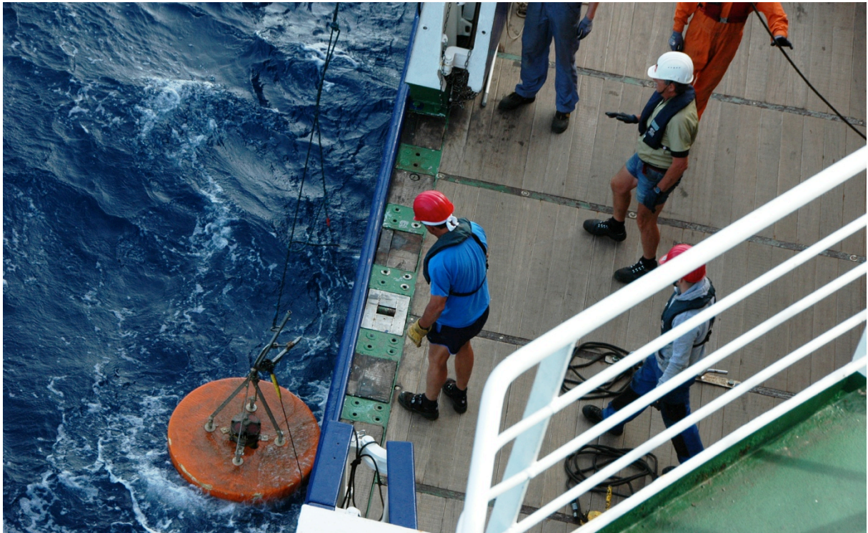
Abb. 3: Aufnahme des akustischen Strömungsmessers aus der CVOO Verankerung (Foto: Michael Schneider).
