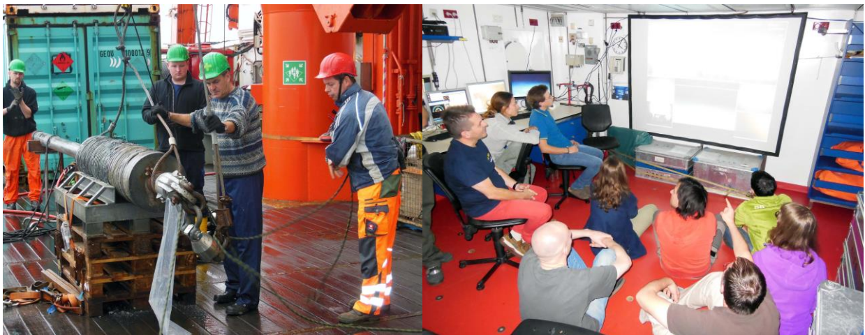
Abbildung 1: Einsatz des 3 m langen Schwerelotes zur Beprobung der Schlammbrekzien ohne Kernabsatzgestell.
