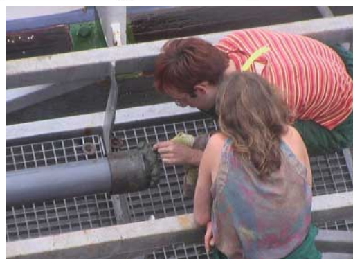
Am Kernfänger eines 3m Schwerelotes: nur wenige Zentimeter des bindigen alten Sediments konnten an Deck gebracht werden.
