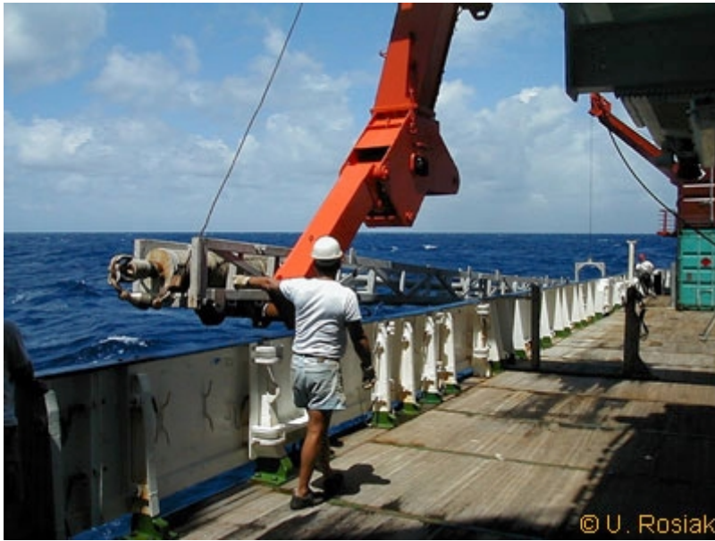
Einsatz des Schwerelotes im Geologie-Arbeitsgebiet vor Surinam.
