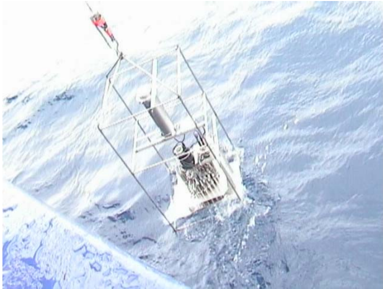
Abb.1 Bremer Freon-Sampler beim Aussetzen. Am unteren Teil sind die Probenbehälter in ihren Halterungen zu erkennen, der obere Teil zeigt die Energieversorgung. Das Gerät soll nach weiteren Tests 2003 in der Labradorsee verankert werden und kann pro Verankerungszeitraum 52 Freonproben nehmen.
