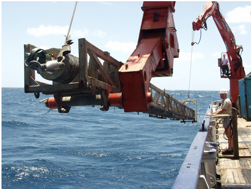
Aussetzen des Schwerelotes auf dem Sedimentfächer des Limpopo
