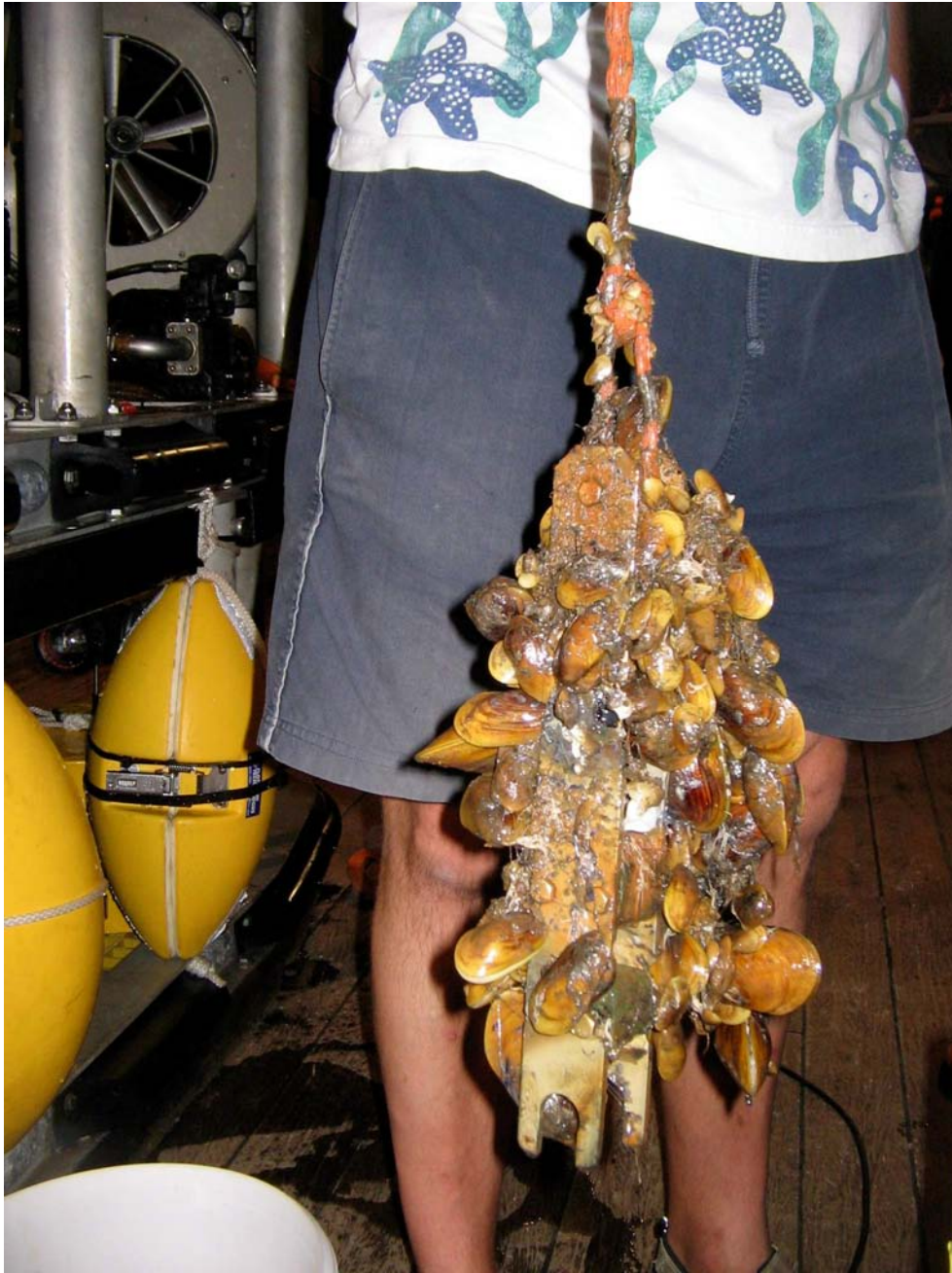
Abb. 2: Temperaturlogger mit Muschelbewuchs innerhalb von 15 Monaten.
