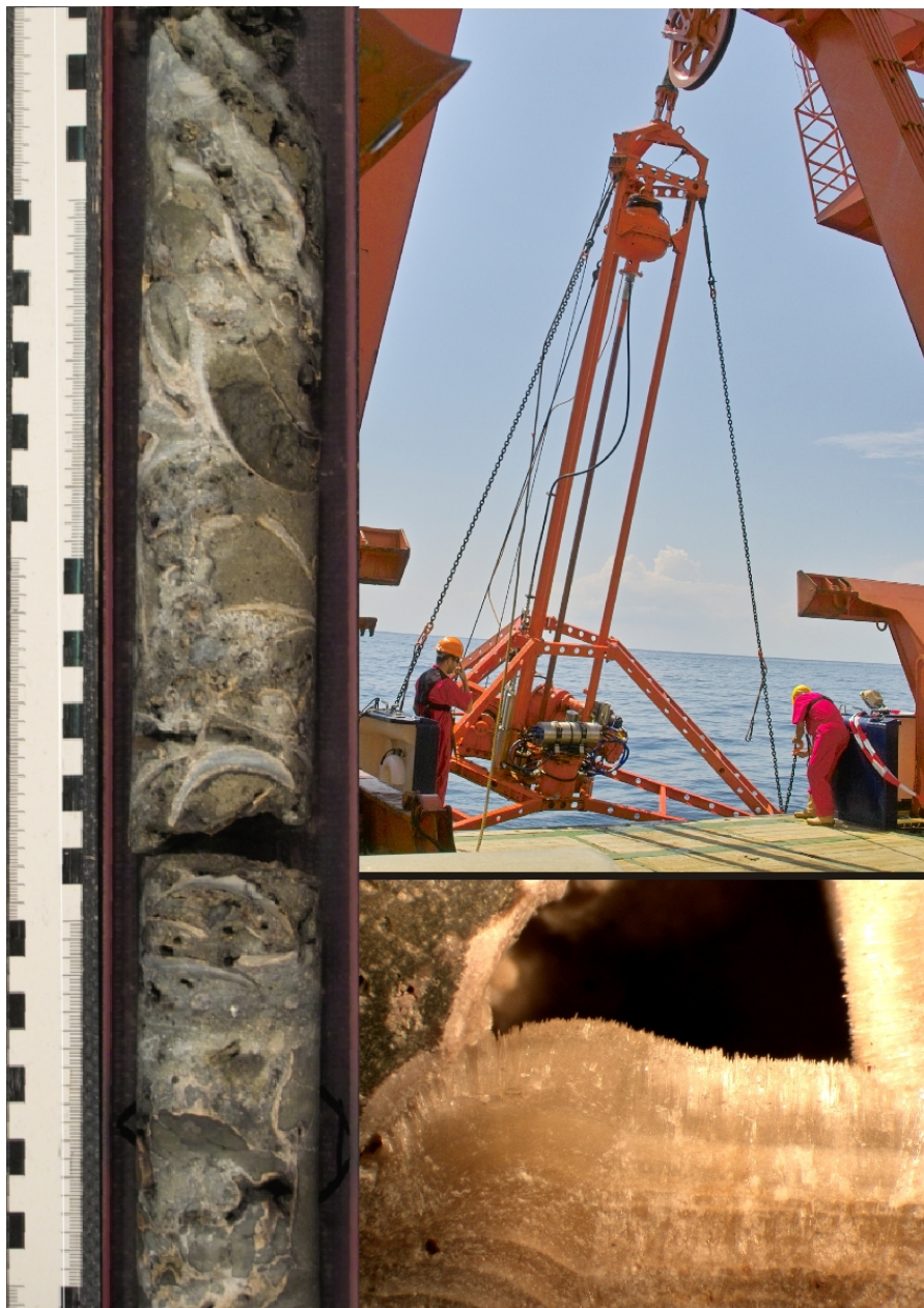
Abbildung 1. Einsatz des BGS Rockdrill Bohrgerätes auf Meteor M66/3a (oben), Kern M66/129- Mound Iguana (links), kalzitische Füllung (unten)
