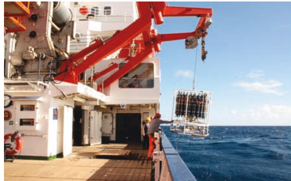
Die CTD mit Rosettenwasserschöpfer wird nach erfolgter Probennahme in bis zu 1000 m Tiefe wieder eingeholt. [Foto: Lisett Kretzschmann]
