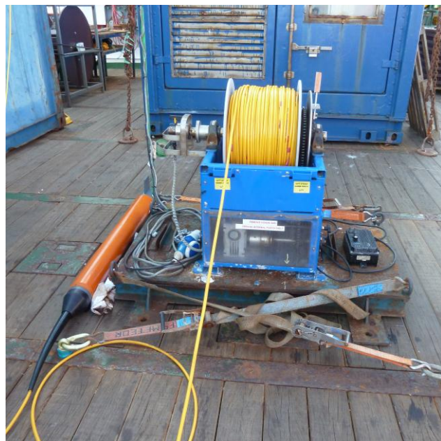
Abbildung 2: (Links) Lacoste & Romberg Seegravimeter zur Vermessung des Schwerfelds auf See, (Rechts) Seaspy-Magnetometer zur Vermessung des Magnetfelds auf See; beide Geräte wurden von den Britischen Projektpartnern aus Durham mitgebracht und betrieben.
