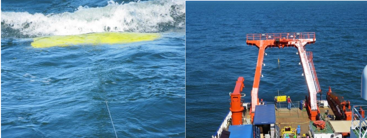
Abb. 4: Bergung des Scanfishs nach erfolgreichem Einsatz
