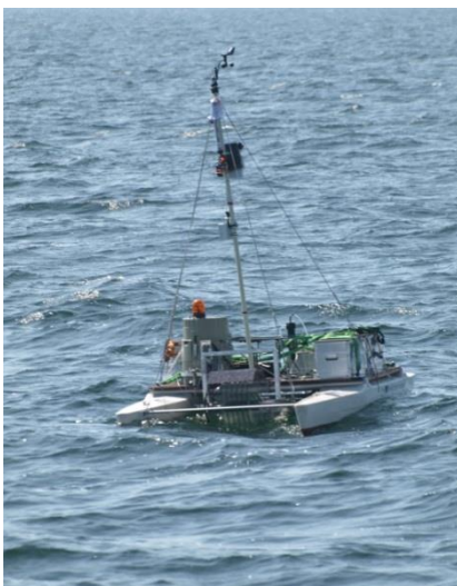
Abb. 4: Ferngesteuerter Katamaran für in situ Messungen und Beprobung von Meeresoberflächenfilmen (Bild: O. Wurl).
