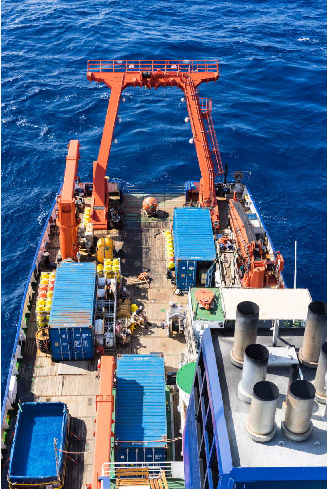
Abb. 1: Blick von der obersten Plattform des Mastes der METEOR auf das Arbeitsdeck während der Aufnahme der äquatorialen Verankerung. Die obersten Instrumente sind schon aufgenommen. Man sieht die beiden ADCPs (akustische Strömungsmesser) auf dem Arbeitsdeck, die durch ihre akustischen Signale am Ende der Verankerungsperiode bereits anzeigen, dass sie gut gearbeitet haben (Foto: Christian Rohleder).
