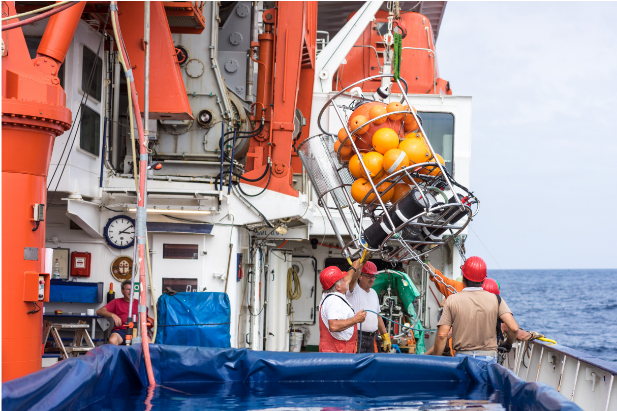
Abb. 3: Aufnahme der Unterwasserwinde (Foto: Christian Rohleder).
