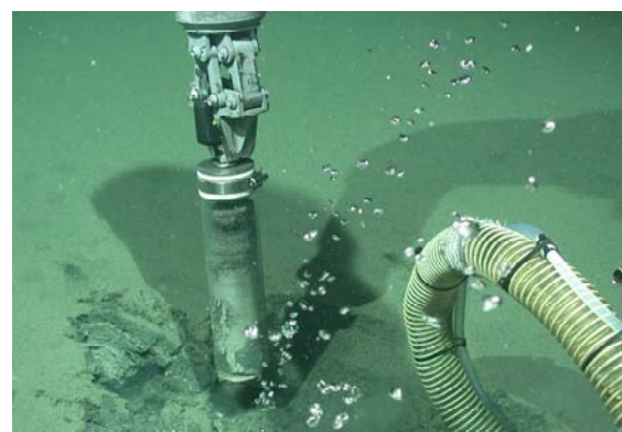
Abb. 3 Ziehen eine Push-cores nahe aktiver Gasaustritte, wobei Gasblasen aus dem Sediment entweichen
