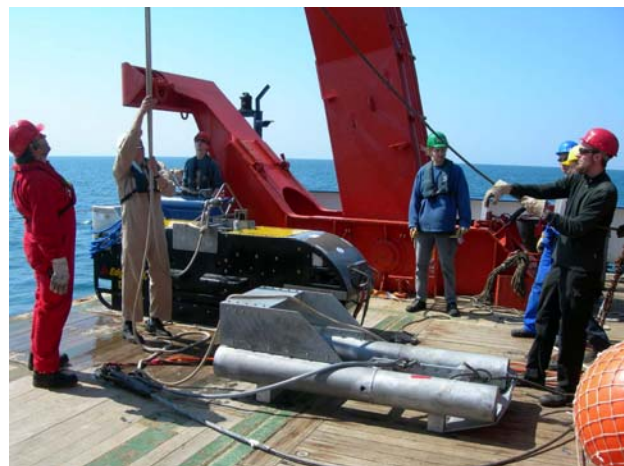
Abbildung 1: Neben der Sediment- und Gashydratbeprobung sind geophysikalische Untersuchungsmethoden während des 2. Fahrtabschnittes der M72/3 von besonderer Bedeutung. Aussetzen des 600m langen Streamers für mehrkanalseismische Messungen (links) und Sidescan Sonar DTS mit Depressor im Vordergrund kurz vor dem Aussetzen auf dem Arbeitsdeck achtern.
