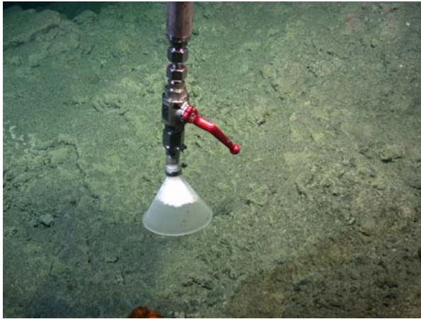
Abbildung 1: Der ROV-gestützte Gasblasenprobennehmer sammelt die vom Meeresboden aufsteigenden Gasblasen in einem nach unten offenen Trichter. Danach wird mit einem einfachen Hebel das Gas in einen Vakuumbehälter darüber eingesaugt (links). Da sich der ROV in 1100 m Wassertiefe im Gashydratstabilitätsfeld befindet, werden die Gasblasen von dünnen Gashydrathäuten umgeben, so dass sie sich im Trichter nicht miteinander vermischen (rechts). Fotos von ROV QUEST (MARUM)
