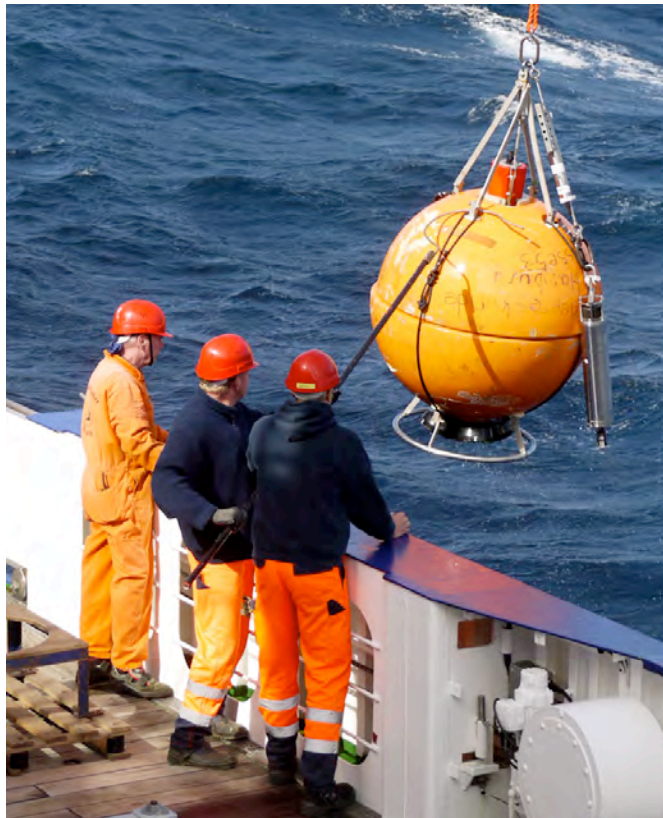
Nach fünf Tagen im Wasser wird die Verankerung geborgen und die Zeitreihen der Strömung, Temperatur und Salzgehalt ausgelesen.
