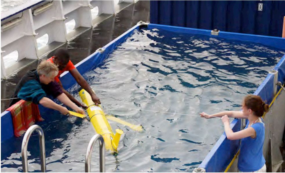
Der GLIDER wird im Pool der MERIAN genau auf die Dichte des Meerwassers eintariert und auf seine Funktionen getestet. Erst dann kann die Auslegung erfolgen.
