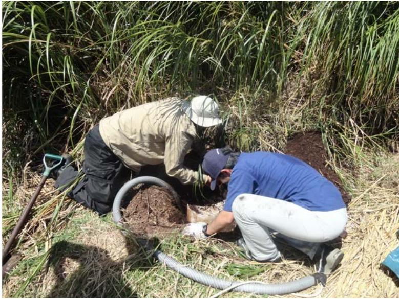
„Bergen“ eines Landseismometers (Foto: O. Schwartz)
