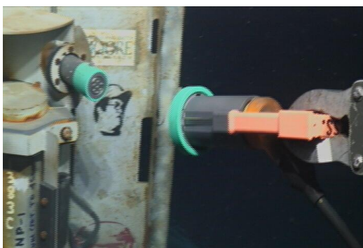
Abb. 2. Herstellen der Steckverbindung zum CORK Datenlogger
