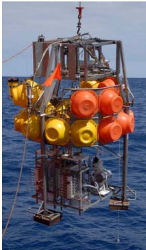
Videogeführter Einsatz des FLUFO. Oben der Launcher, links ein ADCP, unter dem Auftrieb die beiden Mesokosmen und die Meßeinheiten.
